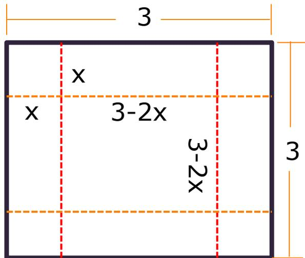
**FIG 1. Vista da placa com o pedaços para cortar.**
